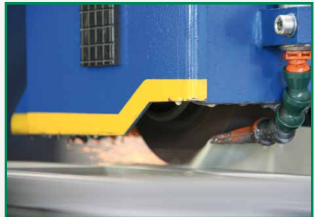
Flachscheifen von Distanzringen, das maßgeblich für die Rundlaufabweichung unserer Spindeln verantwortlich ist. Flat grinding of distance rings, which is in particular responsible for the concentricity deviation of our spindles.
