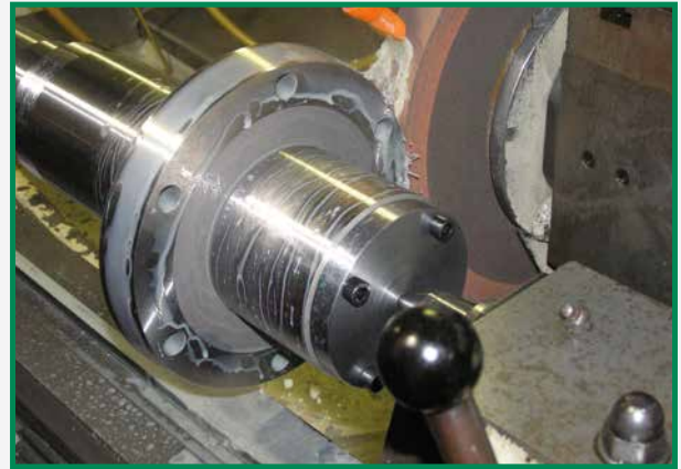
Außenrundscheifen des Kegels 1:4 einer Motorspindelwelle Outside round grinding of the taper 1:4 of a motor spindle shaft
