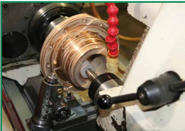
Innenrundscheifen einer Bronze-Gleitbuchse Internal round grinding of a bronze sliding bushing
