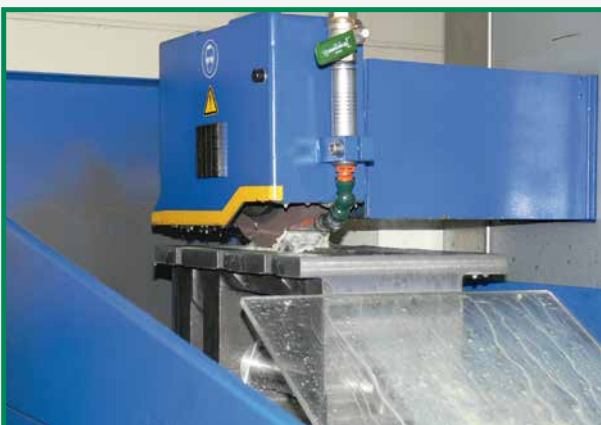
Innenrundscheifen einer Bronze-Gleitbuchse Internal round grinding of a bronze sliding bushing
